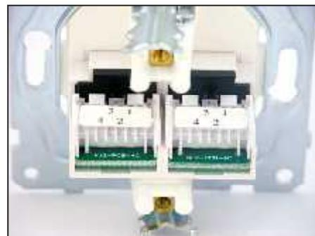
Νέος τρόπος τερματισμού των τηλεφωνικών δικτύων σε κονέκτορες χωρίς εργαλείο. Πλήρης αξιοποίηση της ταχύτητας του δικτύου (10MHz), ευκολία στην εγκατάσταση, μείωση του χρόνου σύνδεσης, ελαχιστοποίηση αποσυστροφής καλωδίων.
